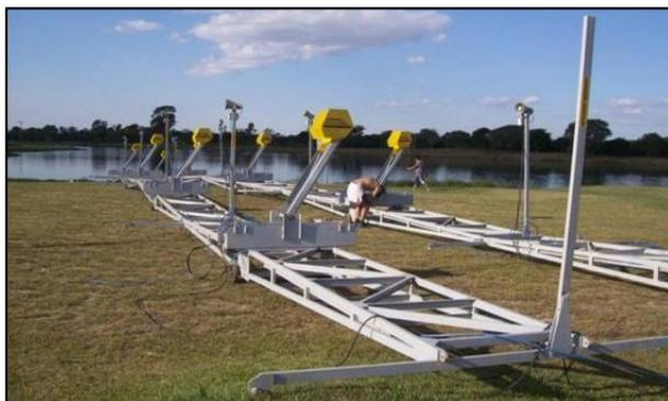
**Figura 20 - Estrutura dos partidores, fora d'água**
