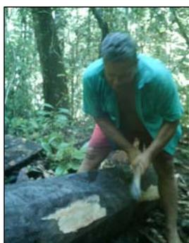
Nesta fase o tronco é virado, e com um instrumento denominado de trincha e ferro de cova, escava-se o tronco até os limites determinados pelo processo anterior as “Brocadas” que servirão de orientações ao limite a ser aprofundado no casco, não permitindo assim que o escultor ultrapasse e estraque ou deixe fragilizado o tronco.
